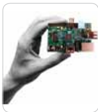
Obr. 7b Multimediálne centrum s ARM11 od Raspberry Pi
